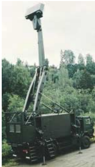
Figure 4.3-p : GIRAFFE AMB surveillance radar.
