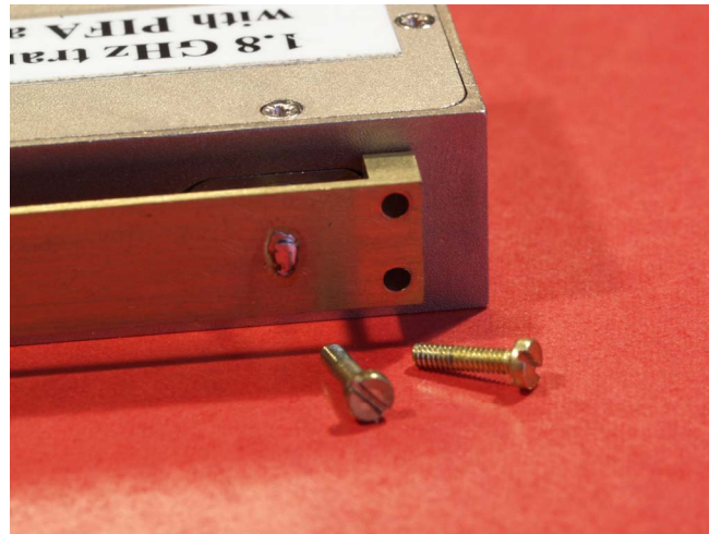
Fig. 25. M2 screws fastening the PIFA.
